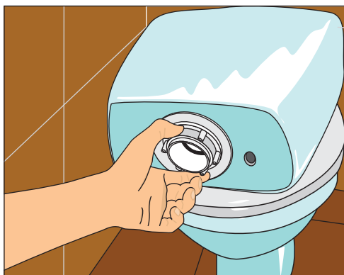
Рис. 11.78. Фиксируем и затягиваем зажимное устройство
