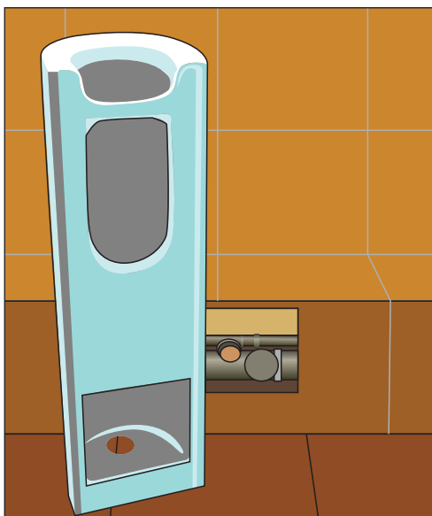
Рис. 10.65. С обратной стороны пьедестал имеет керамические перегородки
