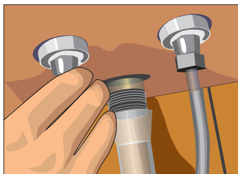
Рис. 10.151. Подсоединяем шланги горячего и холодного водоснабжения
