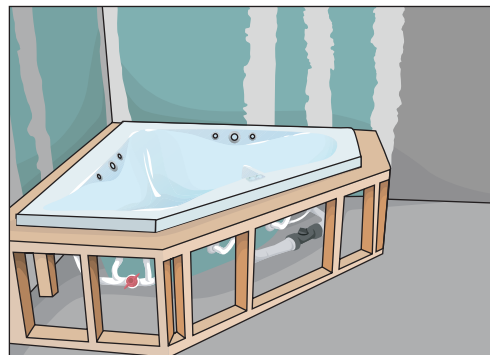
Рис. 10.191. Установка джакузи в деревянный каркас
