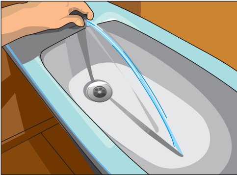
Рис. 10.152. Проверяем герметичность установки — включаем воду
