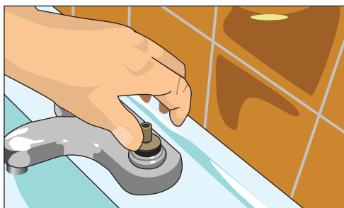
Рис. 11.40. Ввинчиваем новую буксу с новой прокладкой
