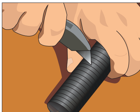
Рис. 10.131. Отрезаем трубу резакom с широким лезвием
