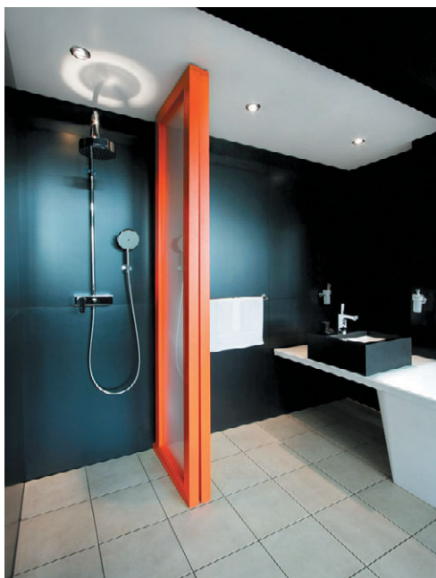
Рис. 10.210. Душевой отсек можно устроить и без кабины, сделав слив прямо в полу, а сам пол — с уклоном
