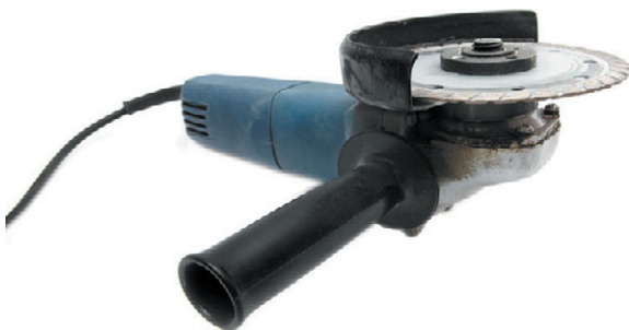
Рис. 1.14. Углошлифовальная машина с защитным кожухом
