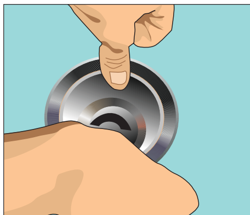
Рис. 11.59. Установленное сливное устройство
