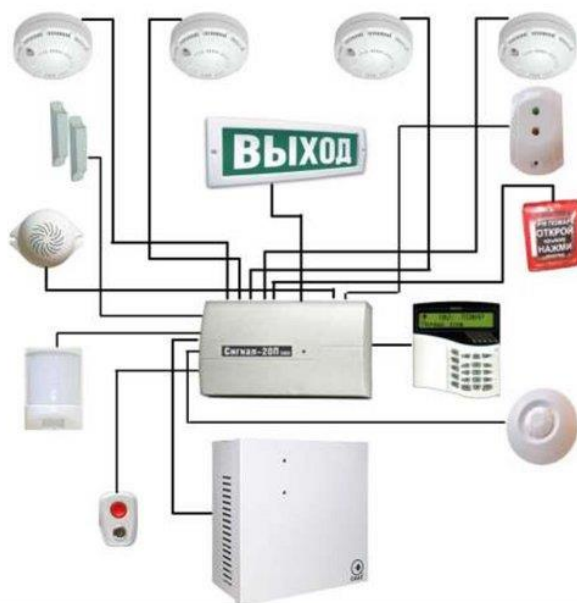
Элементы автоматического управления пожарной сигнализацией
