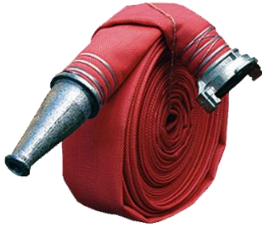
Рукава пожарные напорные с двухсторонним полимерным покрытием на рабочее давление 3,0 МПа
