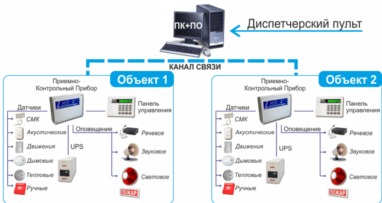
Система охранно-пожарной сигнализации
