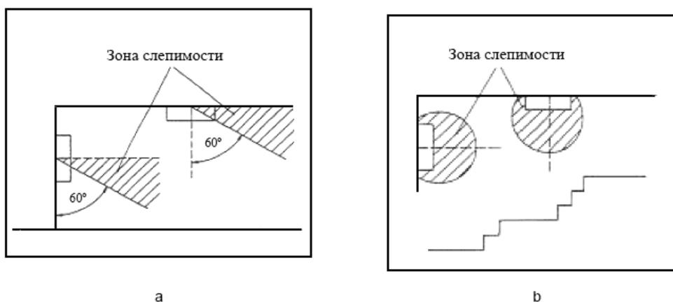
*Зоны слепимости: а - для горизонтальных путей эвакуации; б - для открытых пространств и других путей эвакуации*
