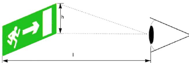
*Определение расстояния различения эвакуационного знака безопасности*
